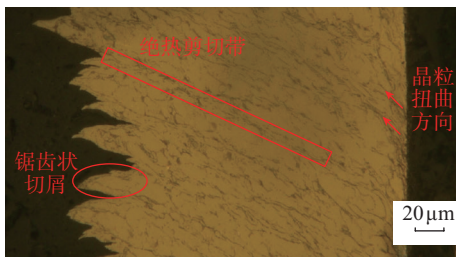
图11 第6组试验切屑金相
