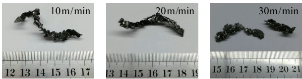
图10 不同切削速度下的切屑形态(进给量为0.04mm/r)
